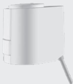
Stetiger, thermoelektrischer Stellantrieb für Heiz- und Kühlanwendungen. Die Ansteuerung des Antriebes erfolgt per 0-10 V DC-Signal von einer zentralen DDC-Anlage oder einem entsprechenden Raumtemperaturregler. Vornehmliches Einsatzgebiet ist der Bereich der Gebäudeleittechnik.
