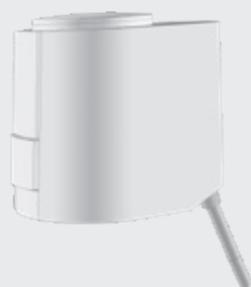
Stetiger, thermoelektrischer Stellantrieb für Heiz- und Kühlanwendungen. Die Ansteuerung des Antriebes erfolgt mit einem 0-10 V DC-Signal von einer zentralen DDC-Anlage oder einem Raumtemperaturregler. Der Antrieb verfügt über einen Rückkanal zur Ausgabe eines 0-10 V-Signals. Dieses gibt der DDC-Anlage Aufschluss über die aktuelle Ventilposition sowie eventuell auftretende Fehler. Vornehmliches Einsatzgebiet ist der Bereich der Gebäudeleittechnik.
