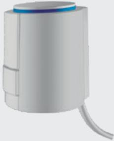
Thermoelektrischer Stellantrieb zum Öffnen und Schließen von Kleinventilen und Ventilen an Heizkreisverteiltern von Flächenheiz- und Flächenkühlssystemen. Vornehmliches Einsatzgebiet ist die energieeffiziente Einzelraumregelung im Bereich der Haustechnik und Gebäudeautomation.
