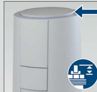
Bei richtiger Anpassung sollte die Hubkappe etwa um 0,5–1 mm aus dem Gehäuse herausragen. Bei zu wenig Überhub ist die Hubkappe bündig, bei zuviel Überhub ist der farbige Bereich sichtbar.
