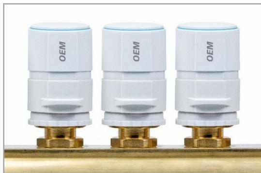
**Bild 4:** Für den Einbau in beengten Platzverhältnissen hat Möhlenhoff den Smart Valve Drive mit 3,5 Millimetern Stellweg und 90 Newton Stellkraft im Programm.
